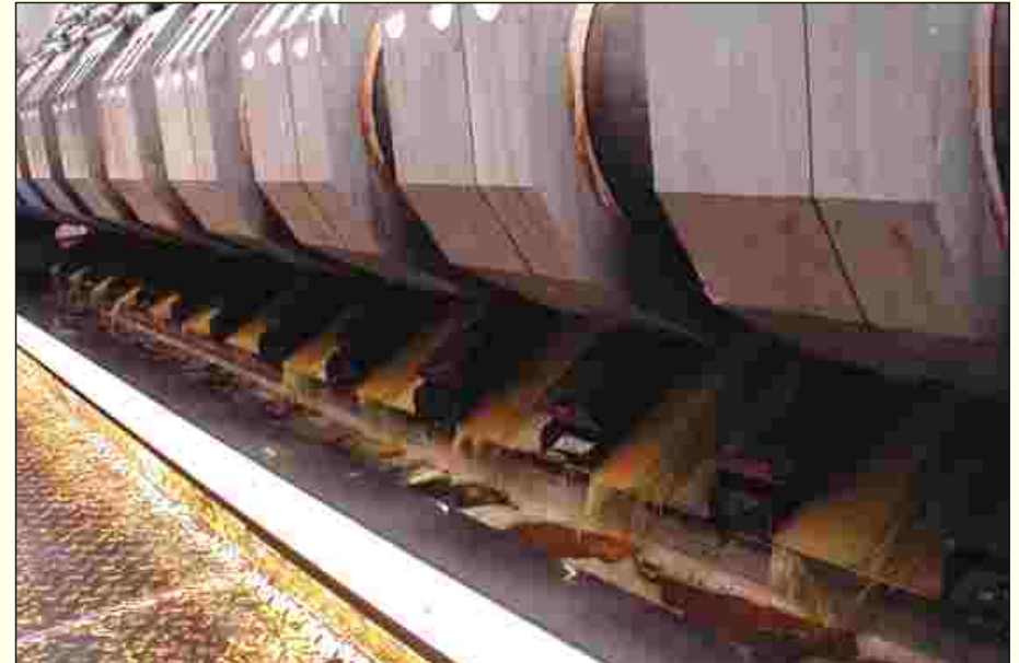
H. 1: Máy ép bột nhão ra bơ và bánh dầu ca cao
